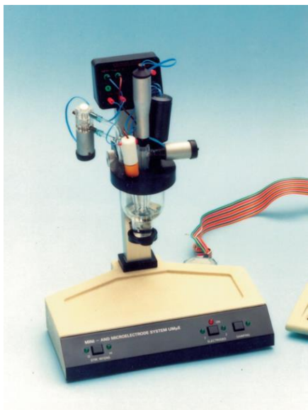
Obr. 60: Příklad provedení počítačového Eco-Tribo Polarografu (PC-ETP) s možným napojením na stolní PC, notebook nebo jinou řídicí jednotku.
