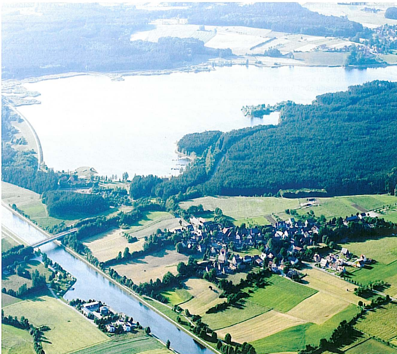
Příkladem pro vodní hospodářství je německý průplav Rýn-Mohan-Dunaj, kde byly komplexně propojeny přehradní nádrže a spolu s průplavem vytvářejí víceúčelový systém pro zadržení a distribuci vody. Na obrázku vpravo od průplavu R-M-D přehradní nádrž Rothsee
